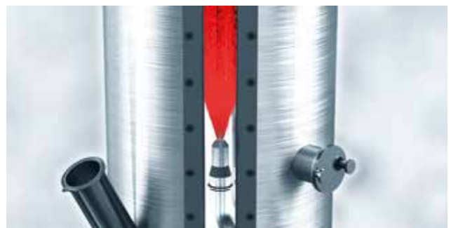
Precursoren werden in den pulsierenden Gasstrom eingespritzt
